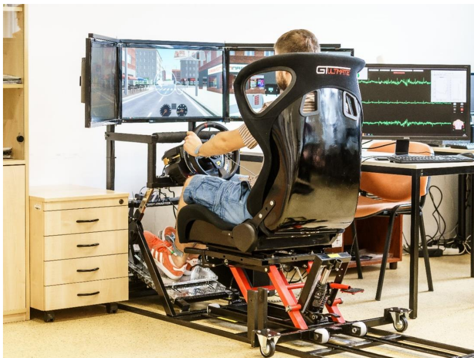
Obr. 1: Celkový pohled na funkční vzorek diagnostického a tréninkového zařízení pro osoby poškození mozku včetně polohovatelného sedadla.
