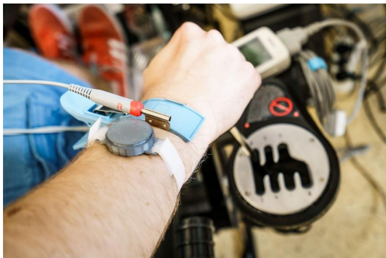
Obr. 1: Detailní pohled na navrženou řadící páku a senzory pro záznam tepové frekvence, akcelerace předloktí a teploty.
